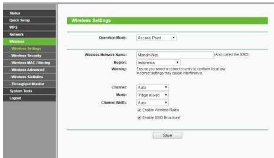
Gambar 8 Konfigurasi Acces Point
