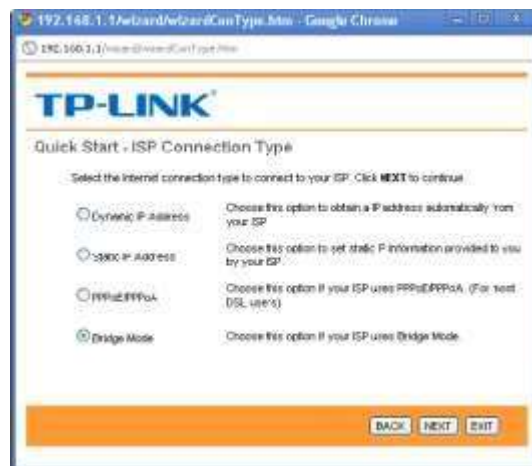
Gambar 5 Mode bridge pada modem adsl speedy
